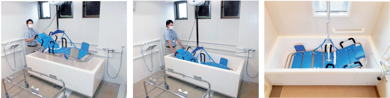
介護リフトで上昇させ吊り上げ部と架台部を分離 介護リフトで下降させ浴槽入浴
